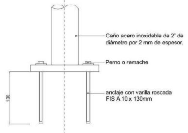
Caño de acero inoxidable de 2" de diámetro por 2mm de espesor.
