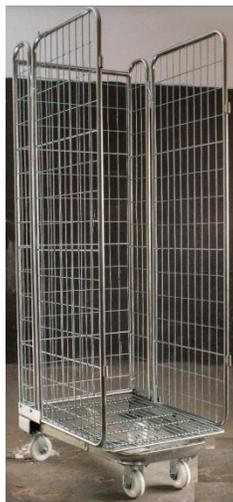
*Incluye 1 base, 1 parrilla, 2 laterales y 1 fondo. Ruedas 125mm (2 fijas y 2 giratorias). Terminación: cincado. Medidas exteriores: Frente 670mm x Profundidad 800m x Altura 1800mm (incluidas ruedas).*
