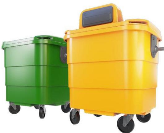
Contenedor y tapa en polietileno resistente a los impactos, con manijas circular de 360° integradas al cuerpo. La apertura de tapa con 2 asas en cada ángulo frontal y su eje de tapa siendo un asa longitudinal en la parte trasera. Los Muñones para levante y servicio del contenedor son en polietileno con refuerzo interior de acero galvanizado y sus bisagras de polietileno de alta resistencia y vida útil, el todo con ruedas normalizadas giratorias de 360° y cubiertas en
